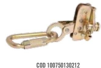
Deslizador para cuerda desmontable Utilizado en Línea de Vida Vertical 16mm (5/8"). Fabricado en acero inoxidable de alta resistencia (22.2 Kn) Máxima fuerza de detención :  $\leq 4.0$  KN Cumple con Recomendaciones de OSHA Incluye mosquetón de acero forjado de 1" abertura. Deslizador freno con dispositivo de seguridad para posicionamiento. Sistema de bloqueo al detectar instalación errónea.
