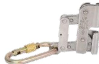
Deslizador para cable desmontable utilizado en Línea de Vida Vertical en cable de 10 mm (3/8"). Fabricado en acero inoxidable de alta resistencia (22.2 Kn) Máxima fuerza de detención :  $\leq 4.0$  KN Cumple con Recomendaciones de OSHA 1926.502/ 1910.66 Incluye mosquetón de acero forjado de 1" abertura. Deslizador freno con dispositivo de seguridad para detención utilizado con cable extendido y tensionado.
